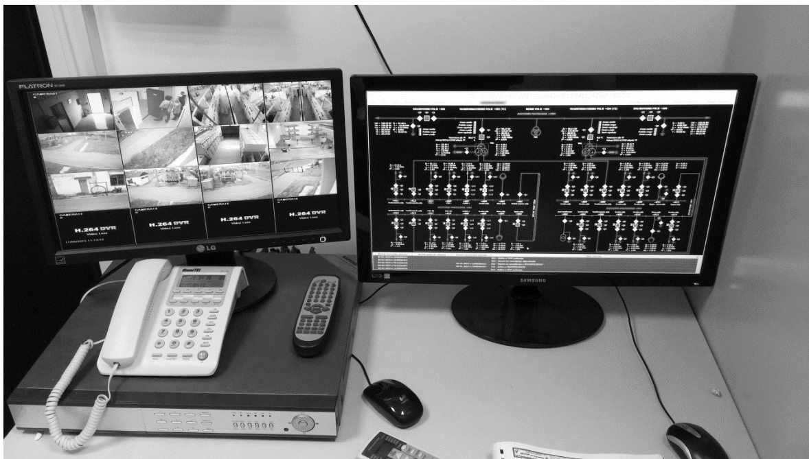
Slika 2. Stanični računar u TS KG 001 "Iličevo"
